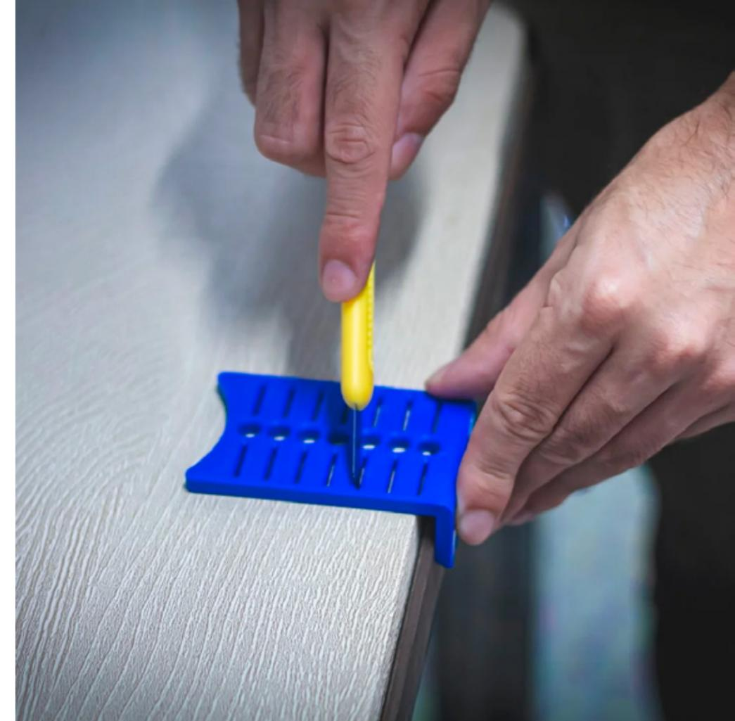
Com furos estrategicamente posicionados, você pode facilmente colocar uma caneta ou marcador e fazer traços precisos na peça. Esqueça as régua complicadas e economize tempo em cada corte. Praticidade é a palavra-chave, substituindo o uso de régua de diversos tamanhos e proporcionando resultados incríveis.
